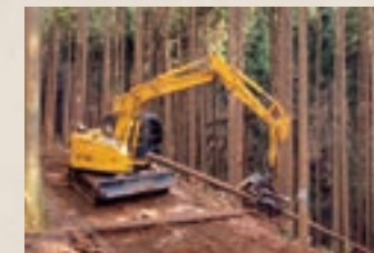
高性能林業機械ハーベスタによる間伐作業
