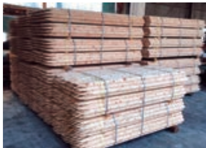
芯材を加工した木杭
